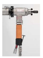
Fresatubi BOILER 1-4 con motorizzazione pneumatica adatta alla prefabbricazione per via del peso ridotto ed estrema maneggevolezza.
